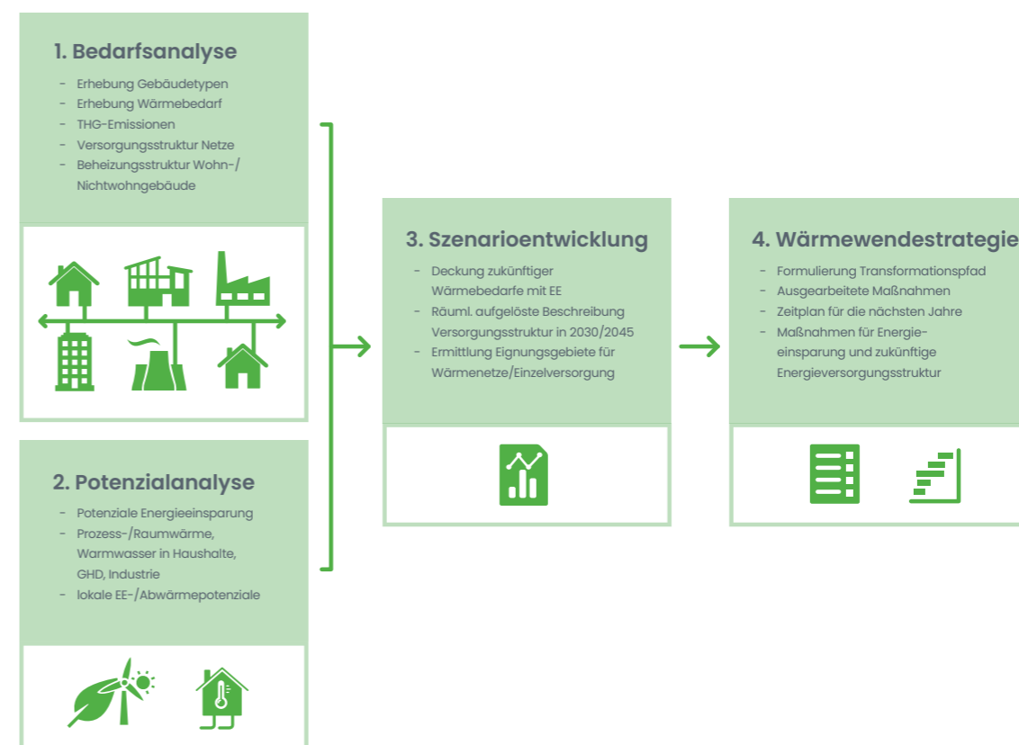
Abbildung 1: Die vier Elemente der Wärmeleitplanung, basierend auf dem Diskussionspapier des BMWK zur flächendeckenden Wärmeplanung
